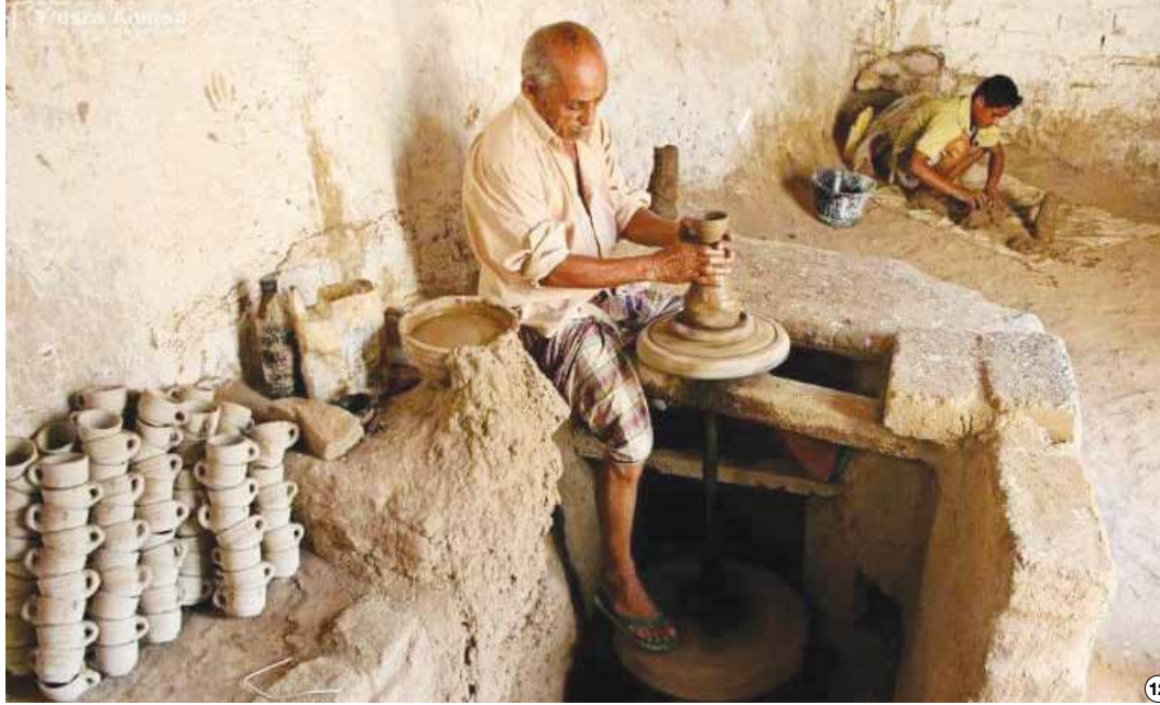
صانع فخار في محافظة الحديدة وتوضح الصورة الدولاب الدري الذي يستخدم لصناعة الفخار في اليمن
