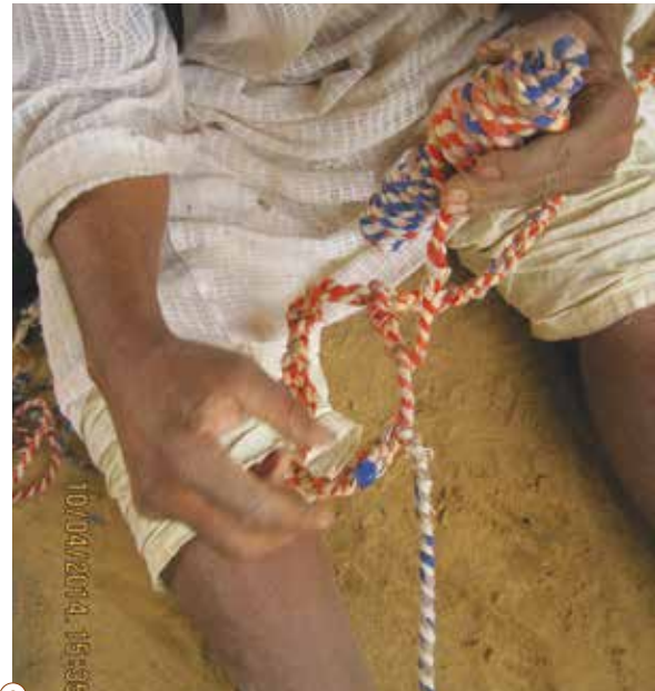
نسيج أول مربع في الشبكة، وذلك بطي الحبل المكسور من مكان إلتقاء حبلي اللفتين. ليعطي ثلاثة أضلاع من المربع ويكمل الضلع الرابع بكسر حبل اللفة التي بيد الحرفي.
