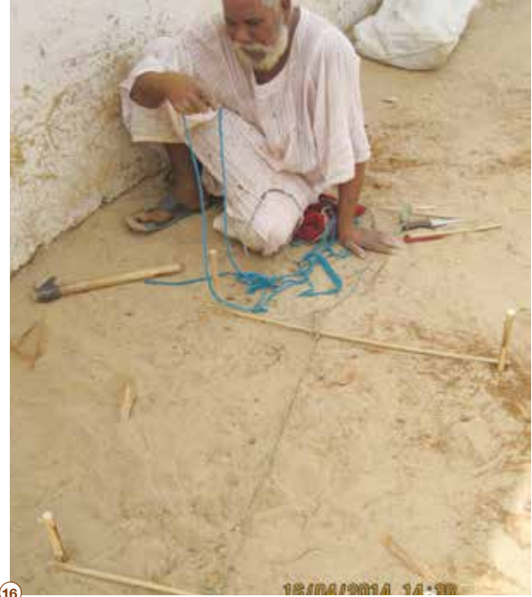
طريقة ربط الحبل ليصل بين الجريدتين، ونلاحظ طرف الحبل المفرد من اتجاه الحرفي
