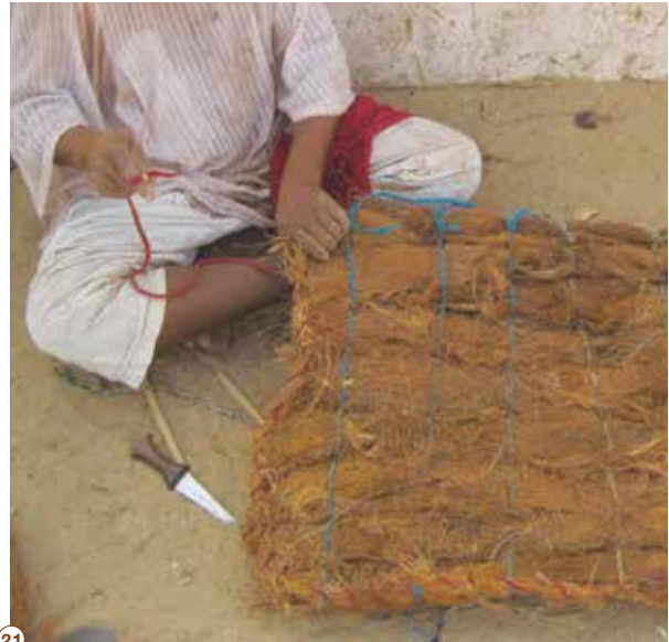
توضّح طريقة حياكة أطراف النسيج، باستخدام إبرة المسلة
