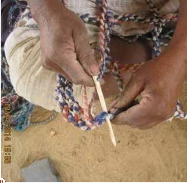
طريقة خياطة الشبكة الداخليّة بواسطة المَسَلّة والحبل الرّفيع، لعمل الشبكة الداخليّة.
