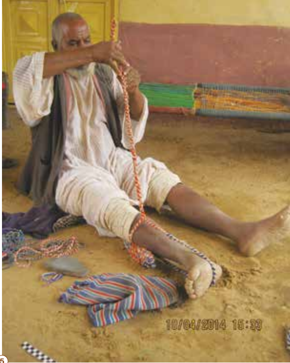
عملية كسر الحبل بين اللفتين بمقدار (3 أشبار و 2 قيراط).
