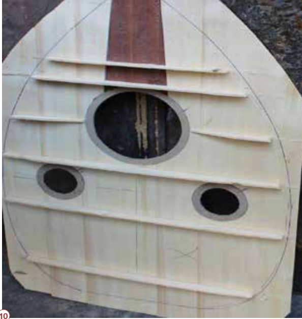
مواقع الجسور وأشكالها وهي قطع من الخشب الرقيق
