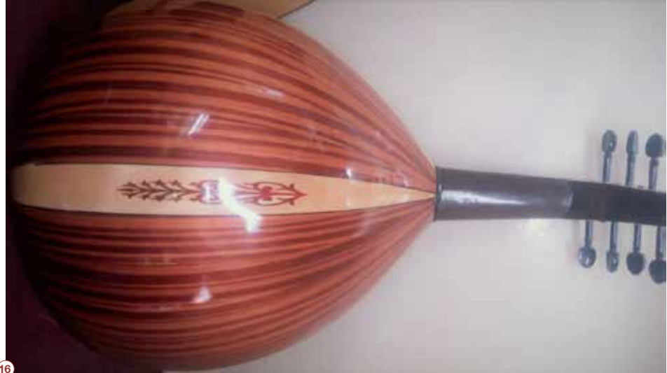
تبين المرحلة النهائية من صناعة العود، حيث يتم بعد الانتهاء من مراحل صقل العود بأكمله بواسطة ورق الزجاج الناعم، وبعدها يتم طلاء العود بمادة خاصة تسمى الدمليك (الكامليا)
