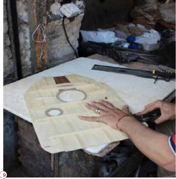
فتحات دخول وخروج الصوت (الشَّمَاسِي) وهي فتحات تساهم في دخول الترددات الصادرة عن الأوتار إلى قصعة العود
