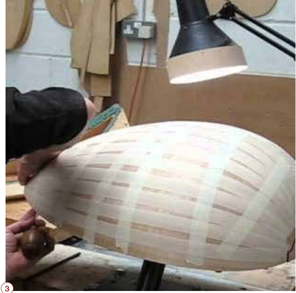
الشكل النهائي لظهر العود (القصة) بعد تثبيت الصانع لجميع أضلاعه والتي عادة ماتراوح ما بين 15-21 ضلعًا ويرجع الاختلاف إلى اختلاف عرضها
