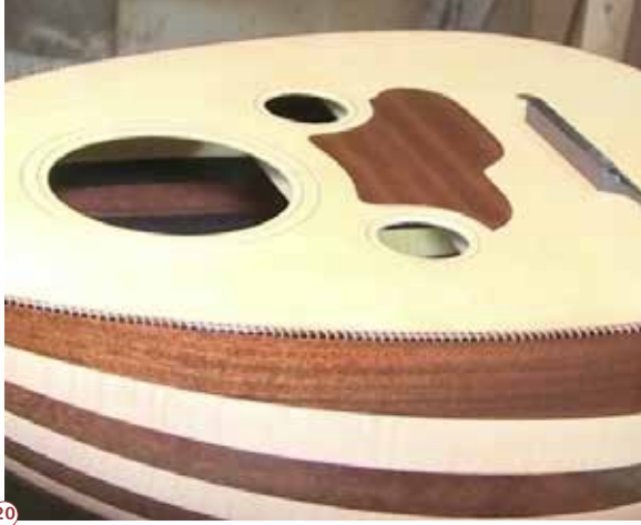
شكل الفتحات البيضاوية وهي فتحات خروج الصوت
