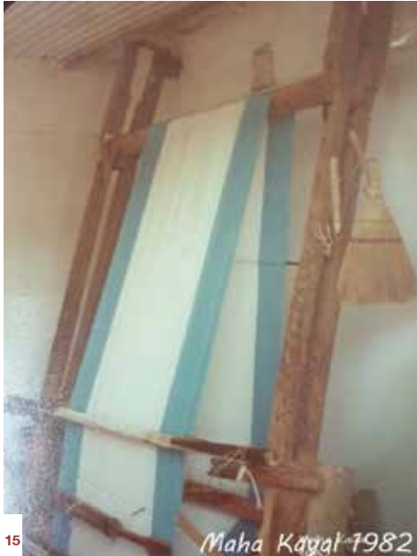
شكل الخشبة العلوية في النول وياخذ قاعدة شكل U
